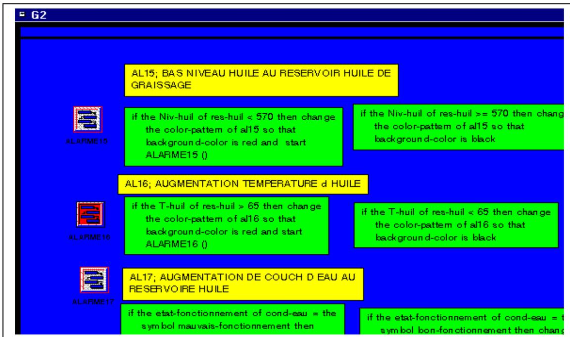
Figure.5.12. Les règles de vérification de l'alarme
