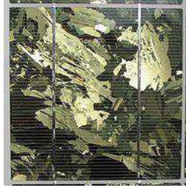
**Fig. 1.13: Une cellule photovoltaïque poly-cristalline [20].**
