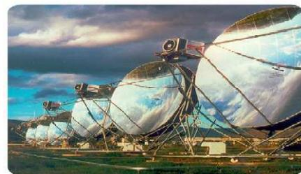
Capteurs thermodynamique paraboliques
