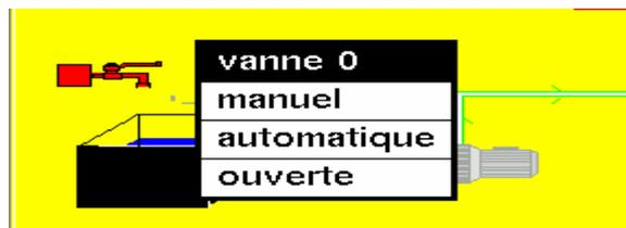
Fig. 4.32.b Commande d'une vanne mode utilisateur
