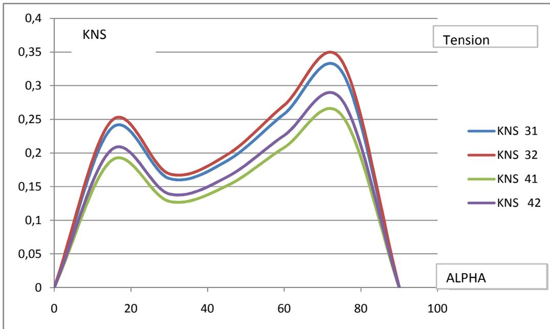
Figure III. 11.b- Caractéristiques de la non sinusoidalité de la tension en fonction de  $\alpha$ :  $\alpha l = \alpha c$  et  $k_2 = 0.1$
