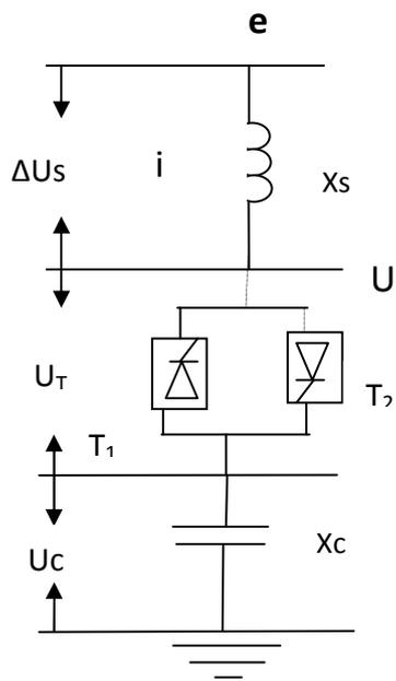
Figure II. 1 Schéma de principe de compensation
