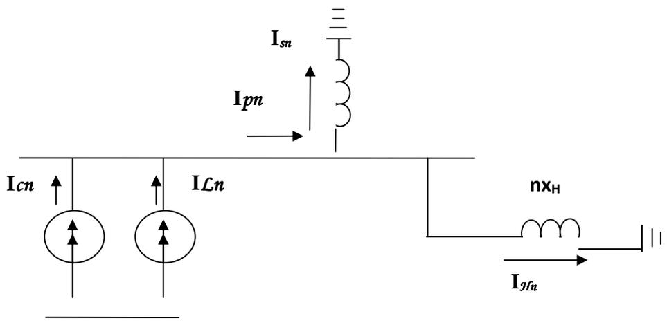
Figure III. 3. c- Schéma équivalent pour le régime  $n^{ième}$  harmonique pour  $\alpha l \neq 0$  et  $\alpha c \neq 0$
