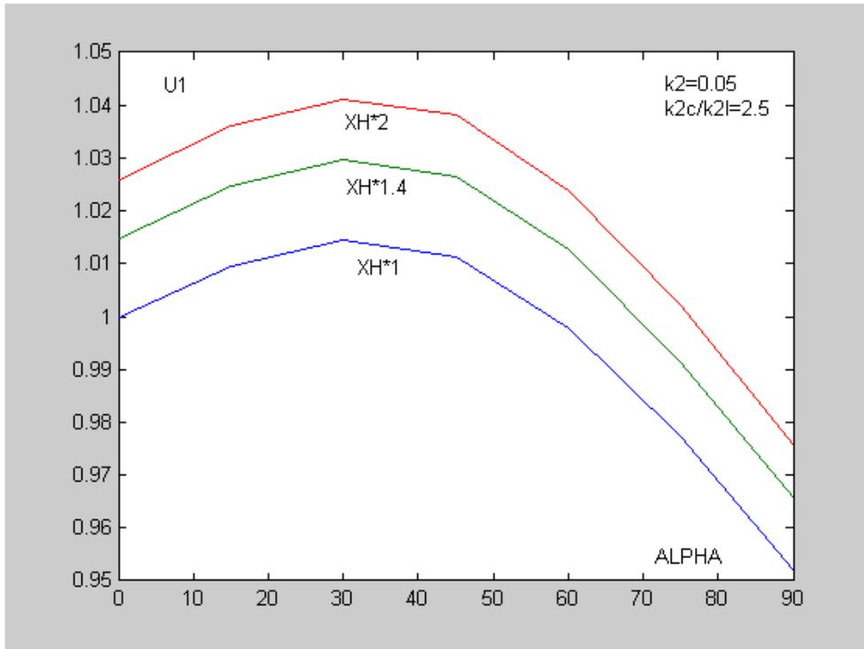
Figure IV. 2. b Caractéristiques des tensions statiques du nœud pour le fondamental,  $k_2=0.05$  et  $k_{2c}/k_{2l}=2.5$
