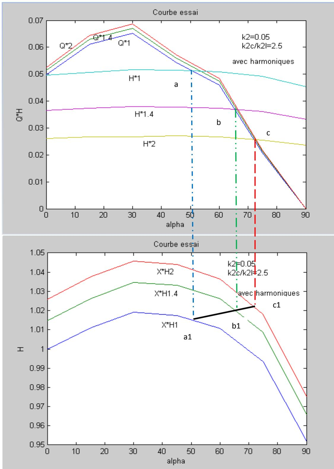
Figure IV. .8 Caractéristiques de réglage du nœud entières,  $k_2=0.05$  et  $k_{2c}/k_{2l}=2.5$
