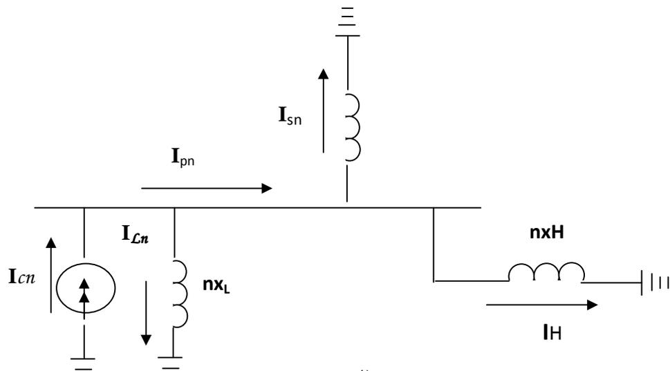
Figure III. 3. b- Schéma équivalent pour le régime  $n^{ième}$  harmonique pour  $\alpha l = 0$  et  $\alpha c \neq 0$
