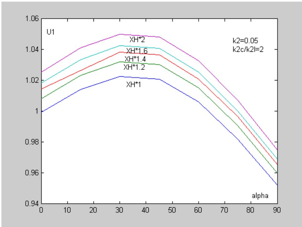
Figure IV. 1. b Caractéristiques des tensions statiques du nœud pour le fondamental,  $k_2=0.05$  et  $k_{2c}/k_{2l}=2$
