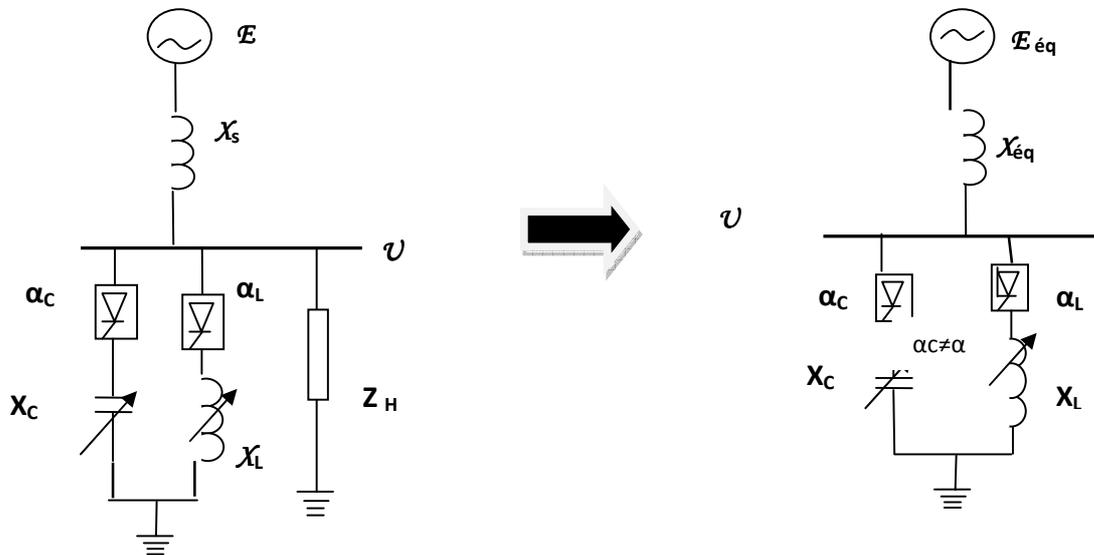
Figure II.2. c Schéma de principe du compensateur branché au nœud quand  $\alpha_L \neq \alpha_c$
