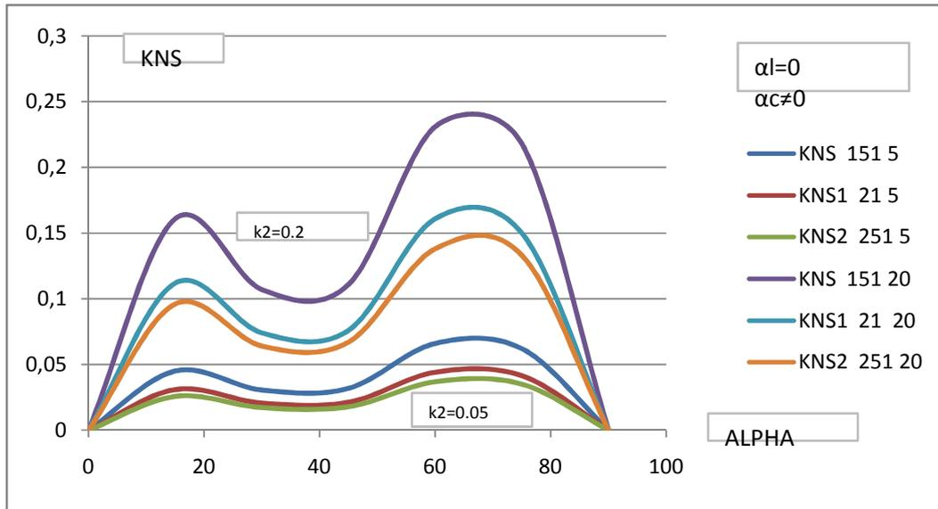
Figure. III.9. Caractéristiques statiques du coefficient de non sinusoidalité du courant,  $\alpha_l = 0$  et  $\alpha_c \neq 0$
