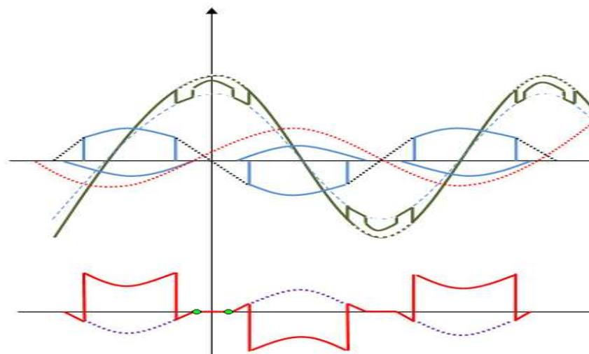
Figure II. 4 Formes d'ondes des courants et tensions quand  $\alpha_L \neq \alpha_C$
