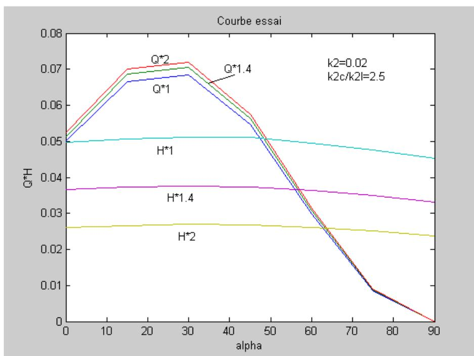
Figure IV.2.a Caractéristiques des puissances statiques du nœud pour le fondamental,  $k_2=0.05$  et  $k_{2c}/k_{2l}=2.5$
