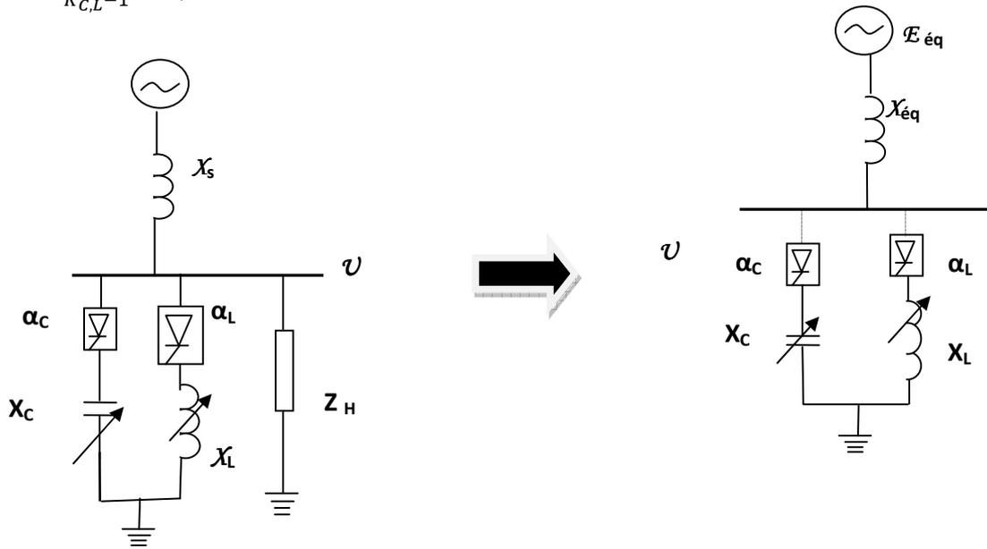
Figure II.2. a Schéma de principe du compensateur branché au nœud quand  $\alpha_L = \alpha_C$
