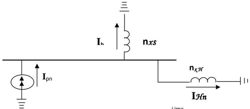
Figure III. 3. a- Schéma équivalent pour le régime  $n^{ième}$  harmonique pour  $\alpha c = \alpha l$
