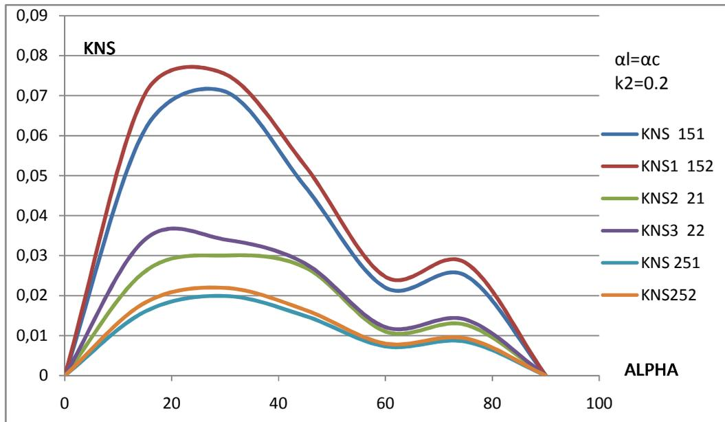
Figure III.6. Caractéristiques de non-sinusoidalité du courant de charge  $k_2=0.2$  et  $\alpha_l=\alpha_c$
