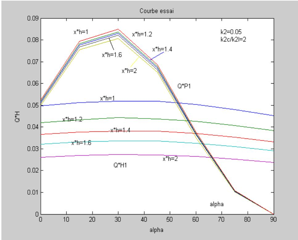
Figure IV. 1.a Caractéristiques des puissances statiques du nœud pour le fondamental,  $k_2=0.05$  et  $k_{2c}/k_{2l}=2$
