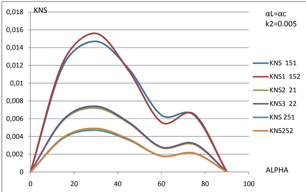
Figure III.4. Caractéristiques de non-sinusoidalité du courant de charge  $k_2= 0.05$  et  $\alpha_l=\alpha_c$
