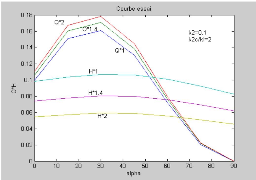
Figure IV.3.a Caractéristiques des puissances statiques du nœud pour le fondamental,  $k_2=0.1$  et  $k_{2c}/k_1=2$
