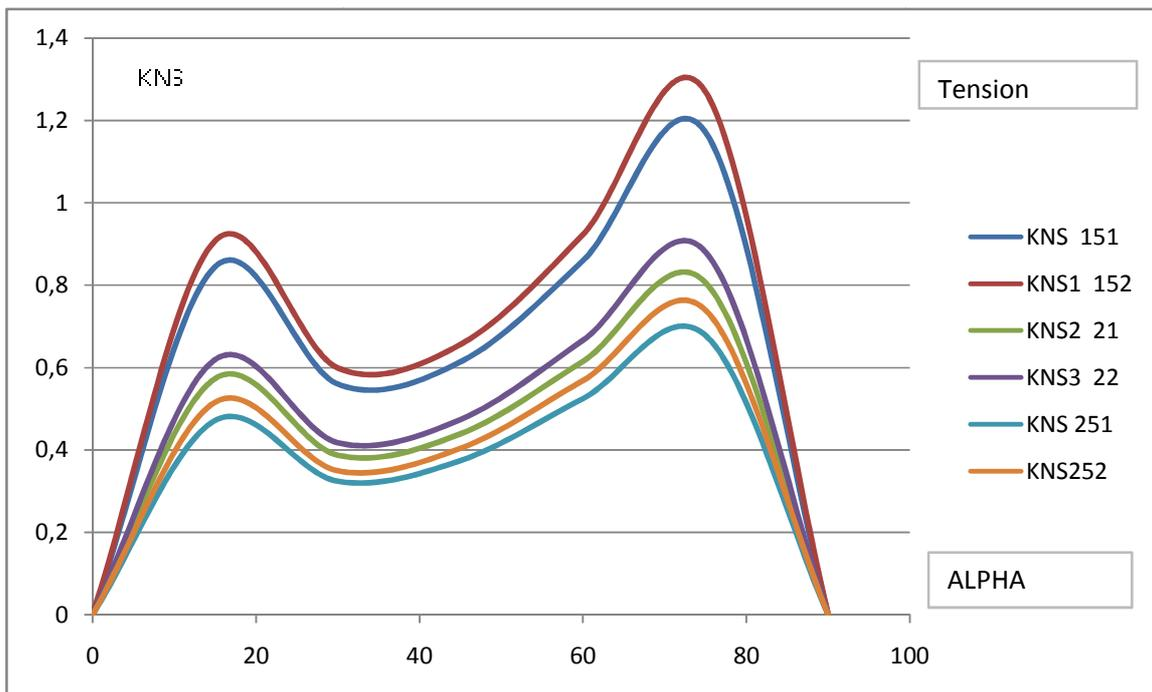
Figure III. 12.a- Caractéristiques de la non sinusoidalité de la tension en fonction de  $\alpha$ :  $\alpha l = \alpha c$  et  $k_2 = 0.2$
