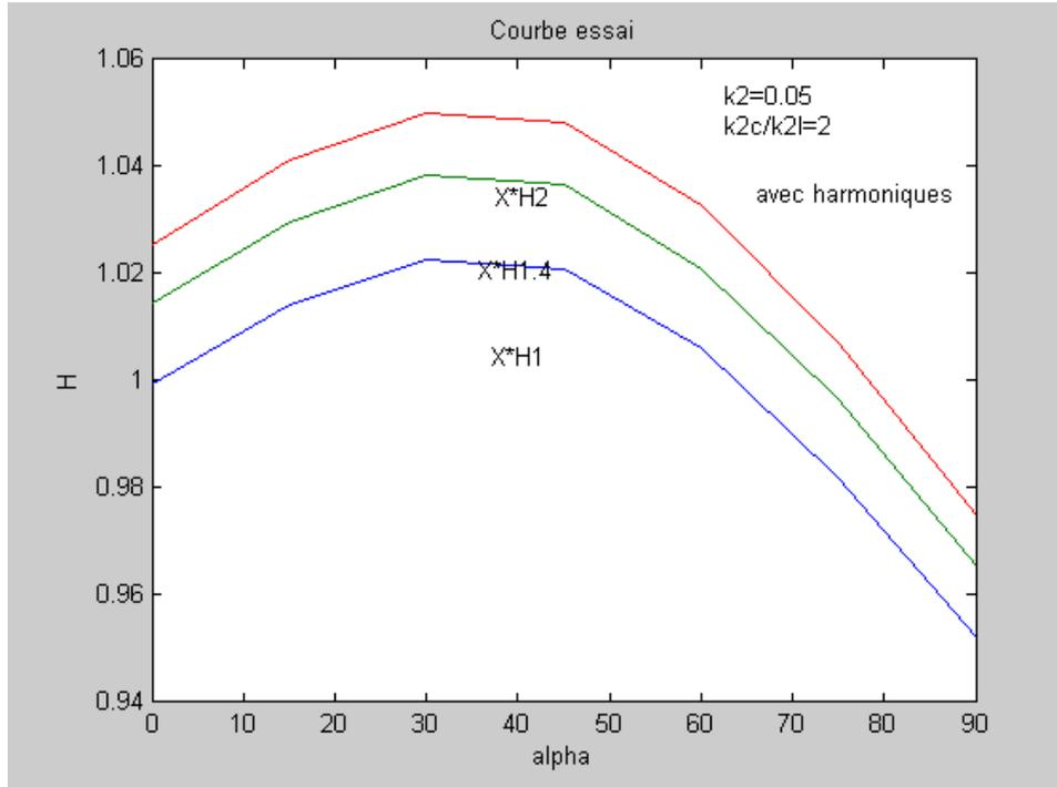
Figure IV 5. b Caractéristiques des tensions statiques entières du nœud,  $k_2=0.05$  et  $k_{2c}/k_{2l}=2$
