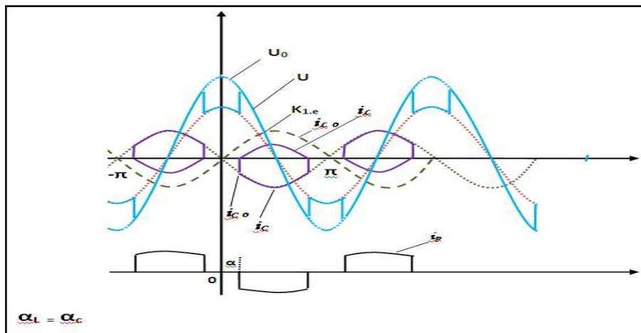
Figure II. 2 Formes d'ondes des courants et tensions quand  $\alpha_L = \alpha_C$
