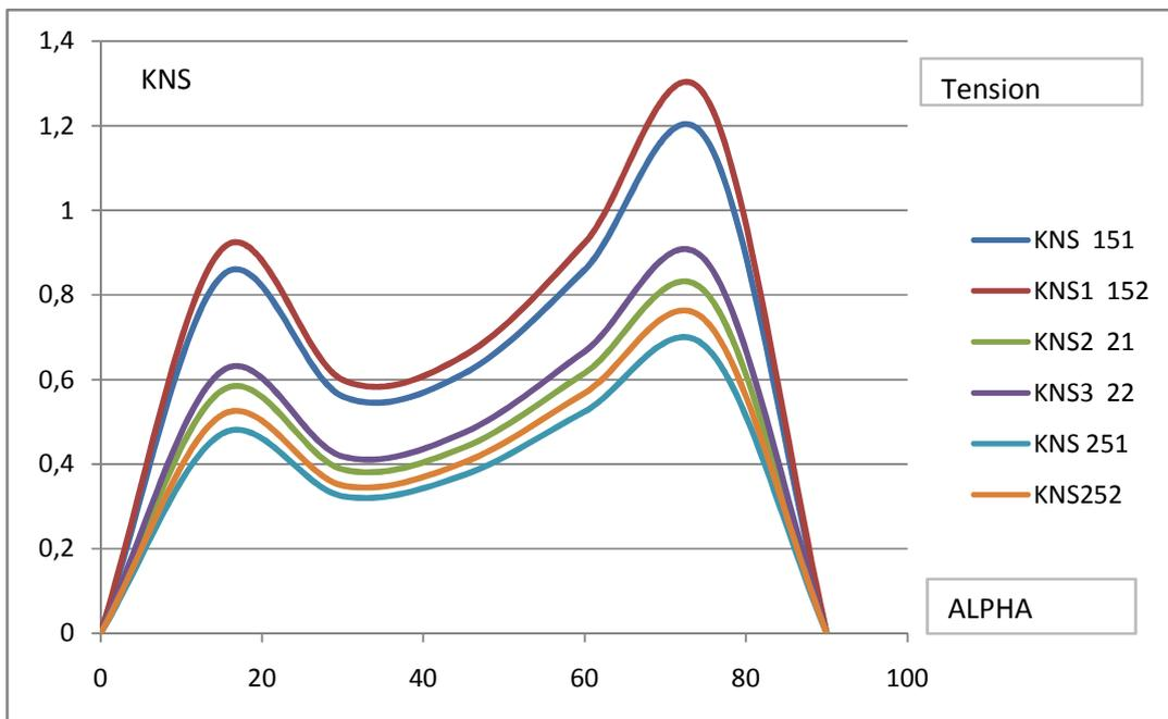
Figure III. 11.a- Caractéristiques de la non sinusoidalité de la tension en fonction de  $\alpha$ :  $\alpha_1=\alpha_c$  et  $k_2=0.1$
