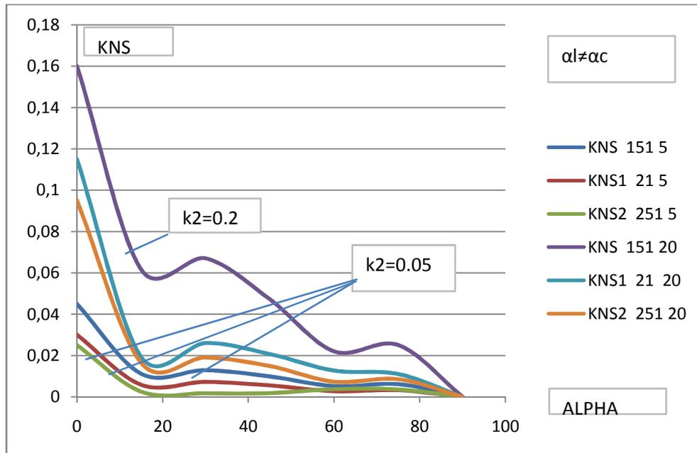
Figure. III.10. Caractéristiques statiques du coefficient de non sinusoidalité du courant,  $\alpha_l \neq 0$  et  $\alpha_c \neq 0$
