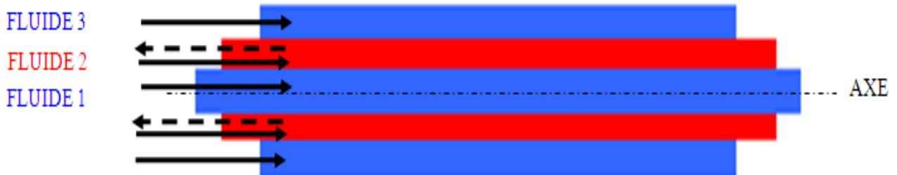
**Figure I-3 :** Coupe longitudinale d'un échangeur de chaleur à triple enveloppe
