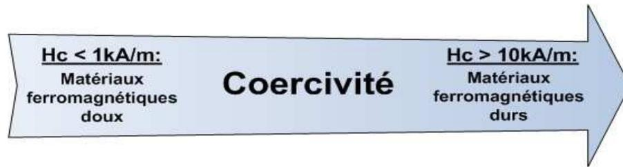
Fig II.7 : séparation entre les matériaux magnétiques doux et durs
