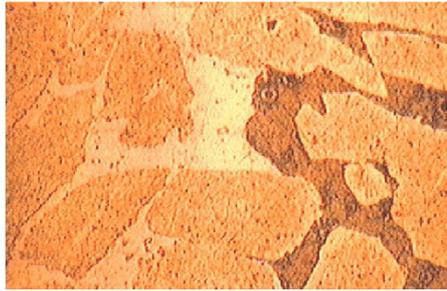
**Figure I.7** Corrosion sélective.
