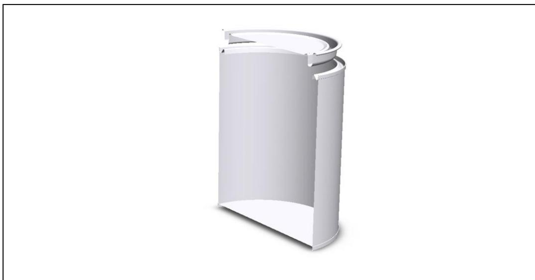
Figure 69. : Une coupe sur la boîte d'emballage métallique 108.5 mm
