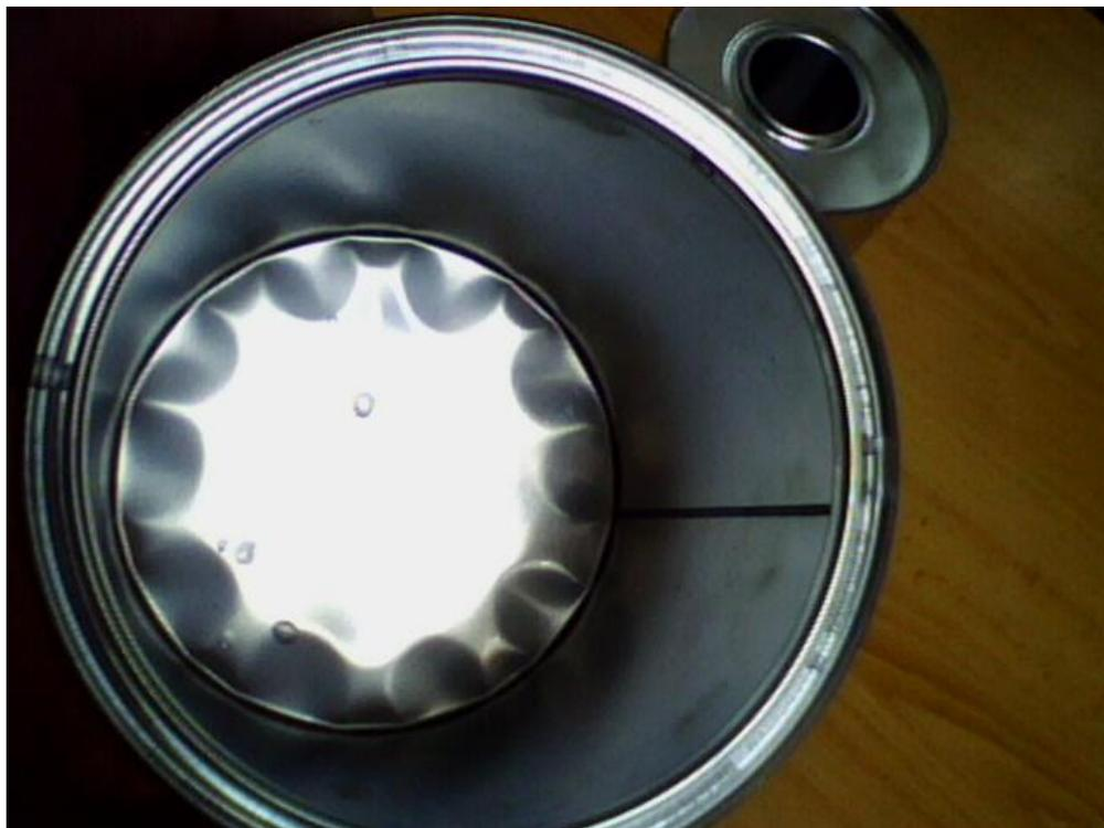
Figure 64. : Image réelle de l'intérieur du fond de la boîte déformée
