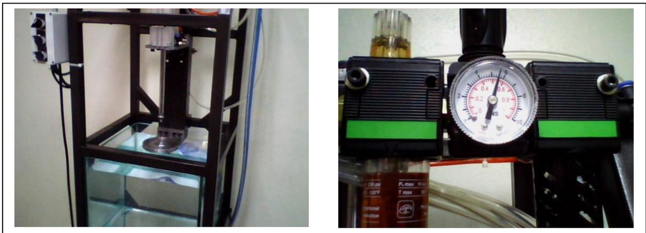
Figure 56. : Dispositif de test et manomètre de contrôle de pression indiquant la valeur approximative de test de 6 bar
