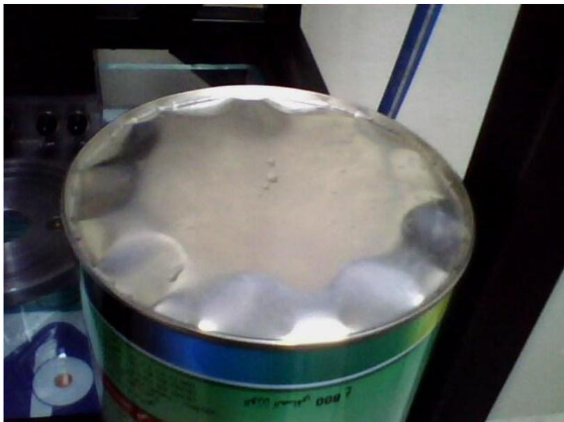
Figure 60. : Image réelle de l'extérieur du fond de la boîte déformée
