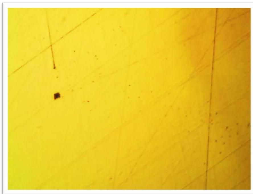
**Figure (IV.16):** Aspect visuel de l'état de surface dans la solution d'eau distillée à un pH = 8,5, échantillon à la réception
