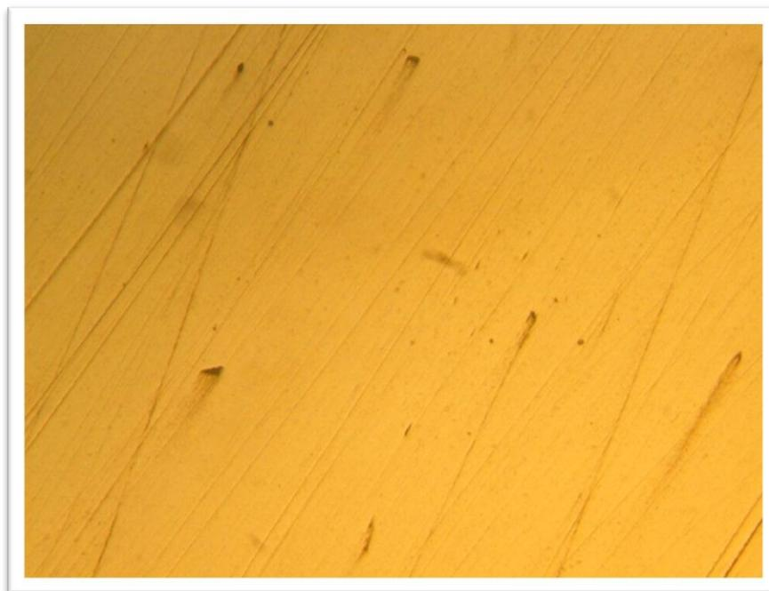
Figure (IV.23): Aspect visuel de l'état de surface dans la solution d'eau traitée à un pH = 7
