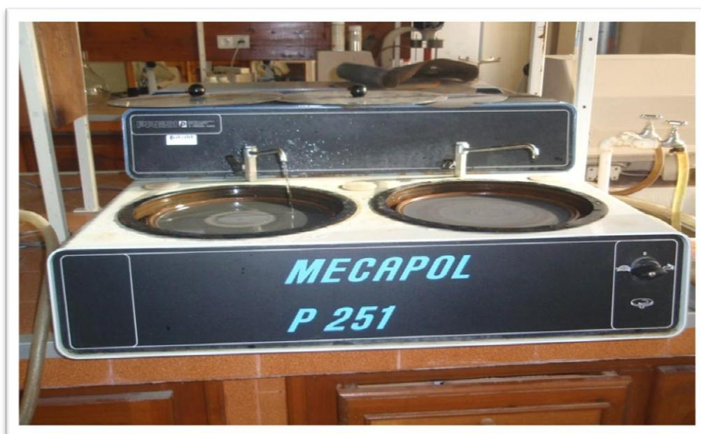
**Figure III.3-** Polisseuse MECAPOL P251
