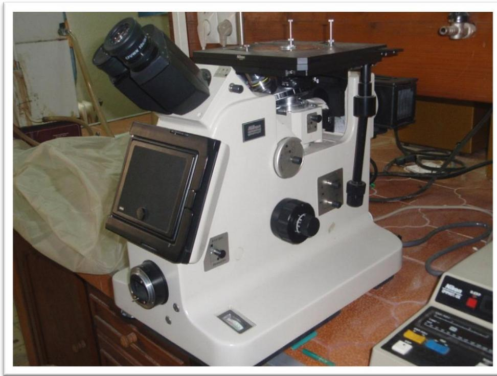
**Figure III.8-** Microscope optique de type « NIKON EPIPHOT »
