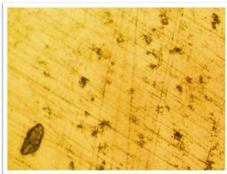
**Figure (IV.6):** Aspect visuel de l'état de surface dans la solution d'eau distillée à un pH = 8,5
