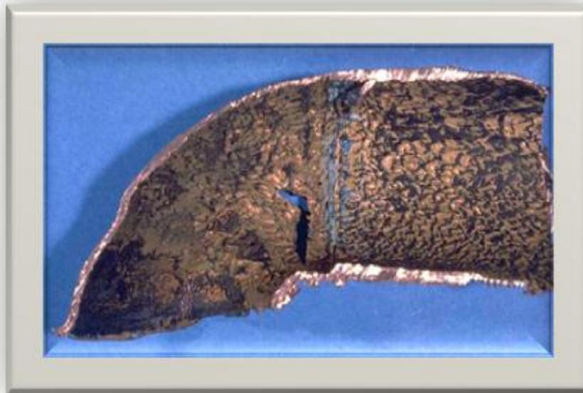
**Figure II.10-** La corrosion caverneuse.
