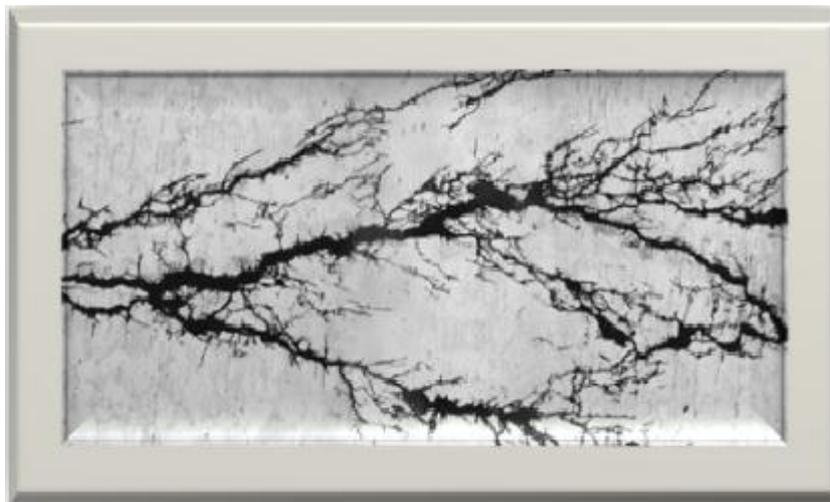
Figure II.14- La corrosion sous contrainte
