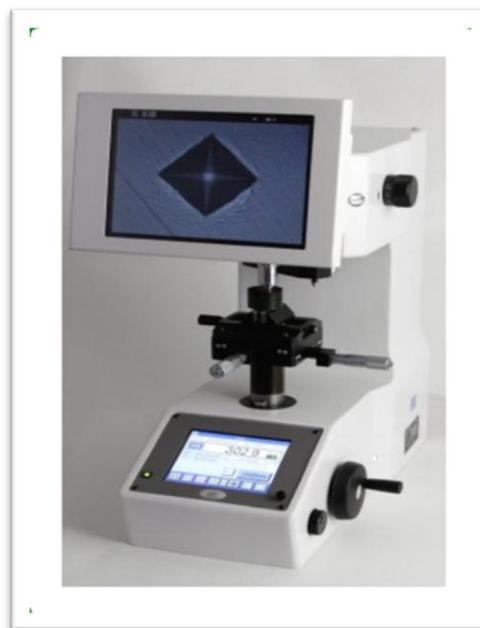
**Figure VI.10-** Machine de mesure de la micro dureté
