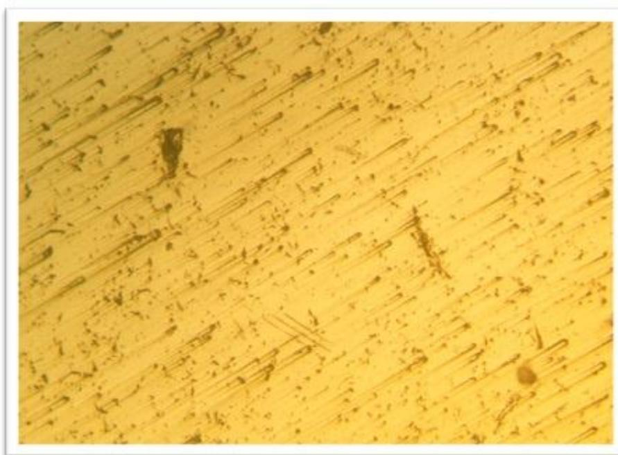
Figure (IV.27): Aspect visuel de l'état de surface dans la solution d'eau traitée à un pH = 5
