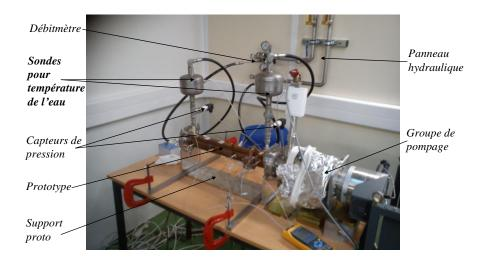
Figure III.15: Schéma hydraulique des deux différents circuits disponibles [79].
