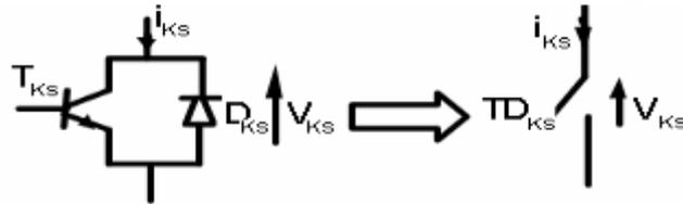
**Figure 3.4** Interrupteur bidirectionnel équivalent à la pair "Transistor-Diode"
