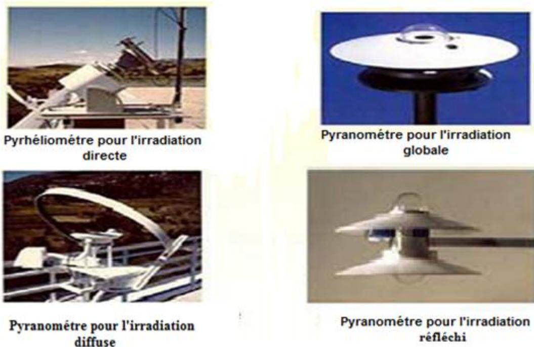
Figure 1.5 : Appareils de mesure de différents rayonnements solaires
