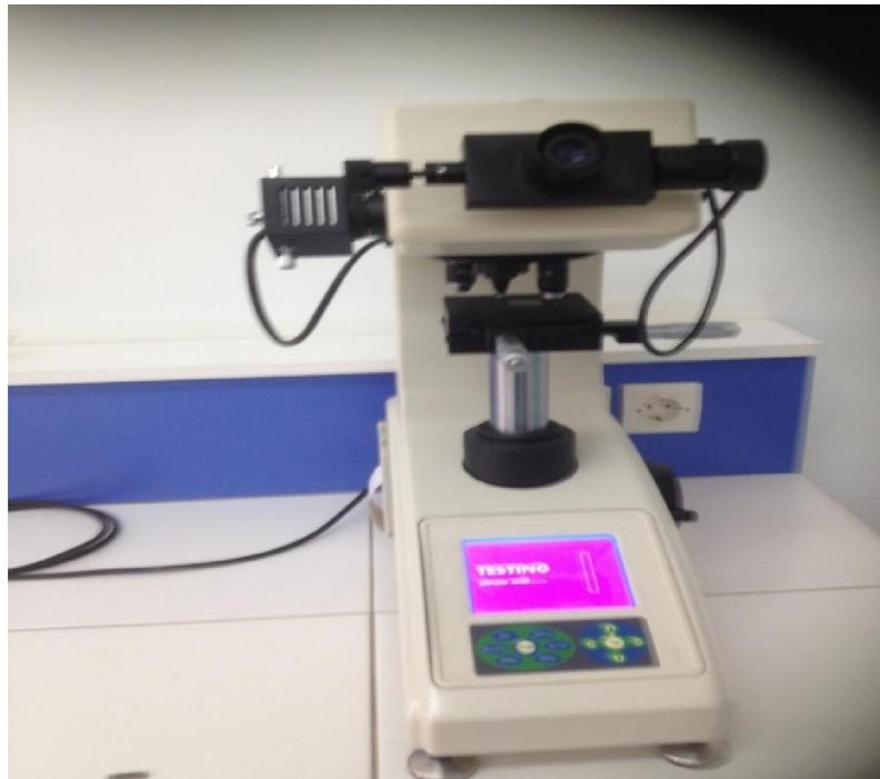
**Fig. 4. 9** Microduromètre (wolpert Wilson model 402 MVD)
