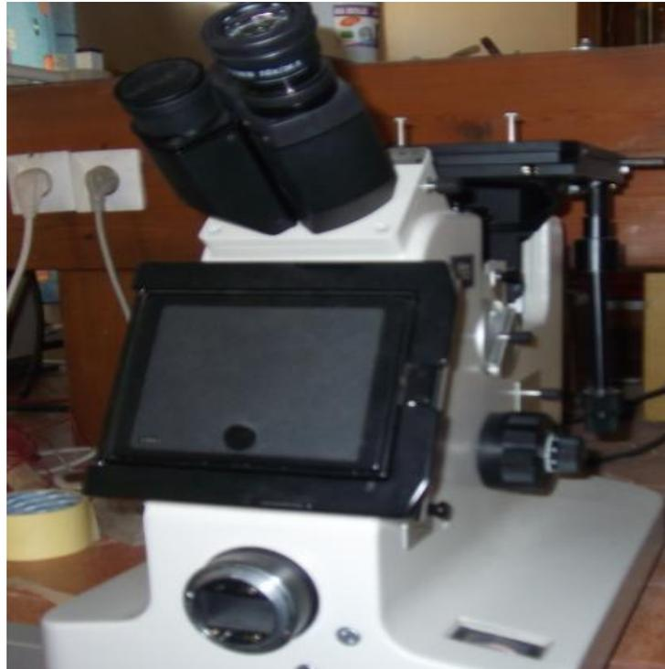
**Fig.4. 6** Microscope optique (Nikon EpipHOT).
