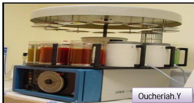
Figure n°16 : automate d'inclusion.
