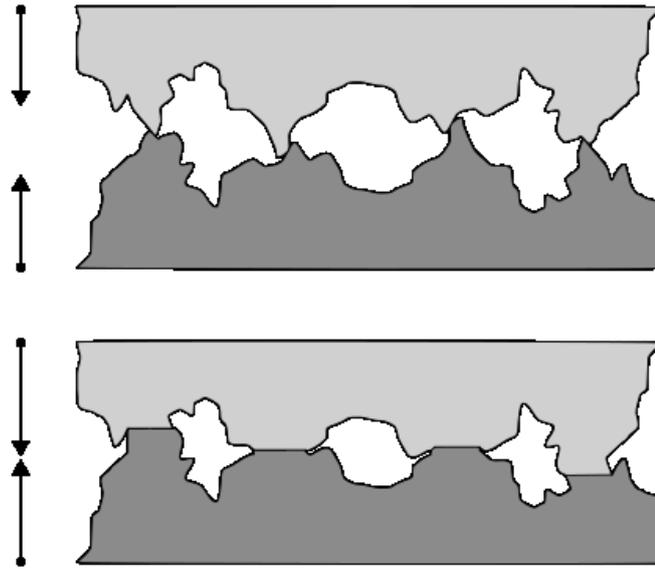
**Figure II.1** Contact des aspérités avec charge et sans charge
