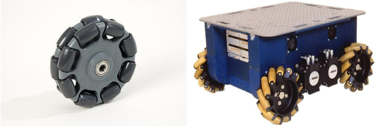
**Figure I.4.** A) Une roue à galets tangentiels (holonomique) B) Uranus le robot holonome
