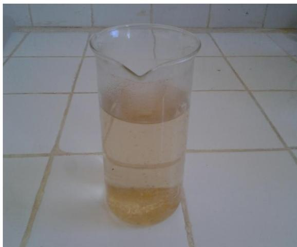
**Figure 12.** Déprotéinisation avec de l'hydroxyde de sodium aqueux (photo personnelle).
