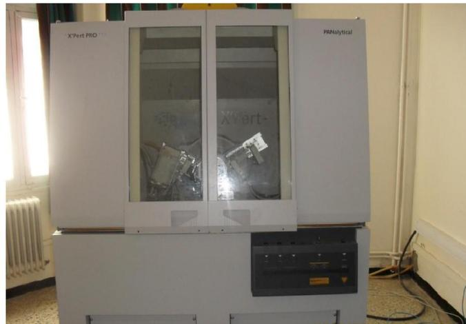
**Figure II.11:** Photo du Diffractomètre « Philips X'Pert » (Département Génie des procédés, Université de Bejaia-Algérie).
