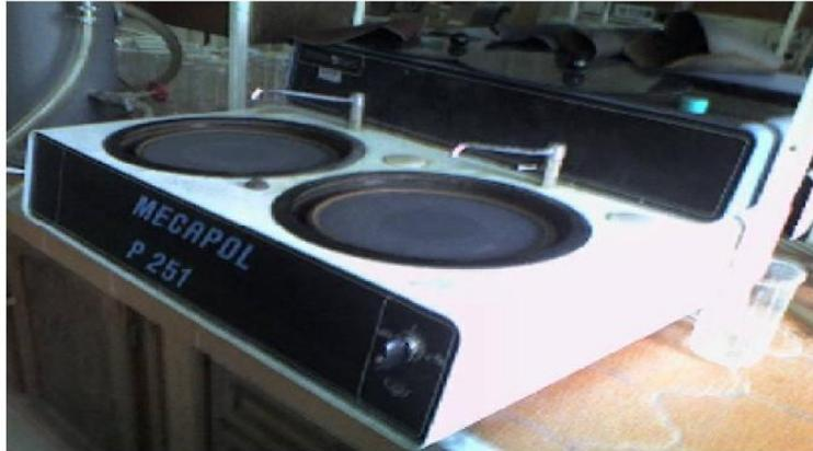
*Figure II.7: Polisseuse à disque (MECAPOLE 251).*
