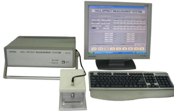
**Figure II.15:** Photo du Effet Hall «HMS-3000» (Laboratoire d'Electrochimie et Matériaux (L.E.M)), Université de Sétif,- Algérie).
