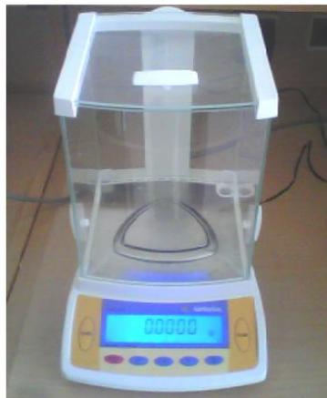
*Figure II.6 : Balance électronique.*
