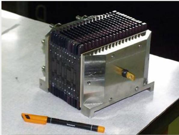
**Figure I.1 :** Pile de 300 We, refroidie à air [24].
