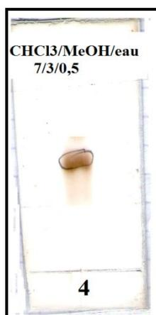
**Figure V.17: CCM (silice en phase normale) du composé 4**
