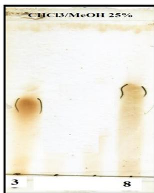
Figure V.10: CCM en phase normale des composés 3 et 8
