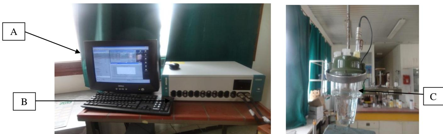
**Figure (II.3) :** le dispositif expérimental Autolab (PGZSTAT 30) utilisé dans les expériences.
