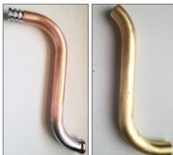
**Figure (IV.10):** tube de robinet en laiton.
