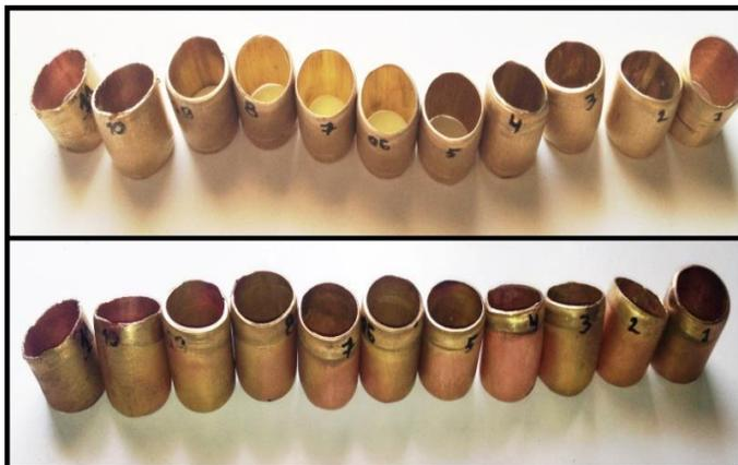
**Figure (IV.11):** Les pièces de laiton avant et après l'électrolyse.
