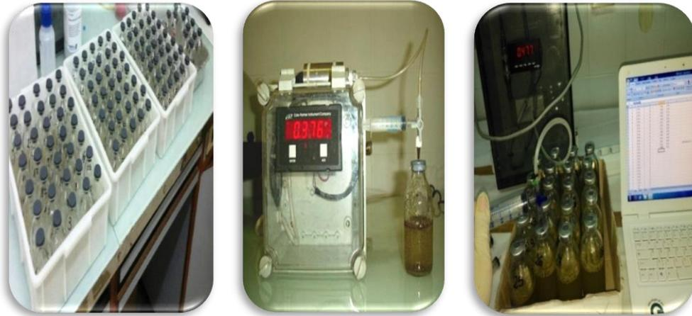
**Figure 21:** Système de fermentation en batch
