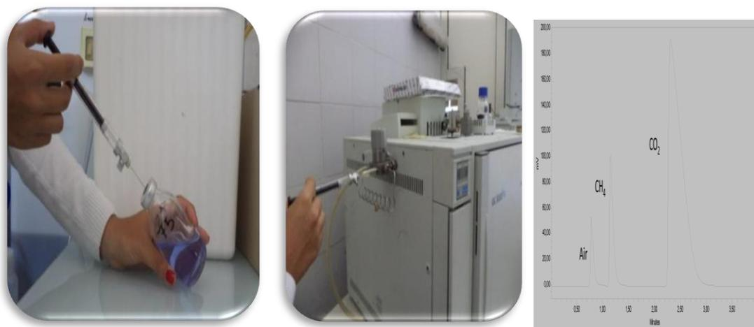
**Figure 22:** Analyse de la phase gazeuse méthane ( $CH_4$ ) et de gaz carbonique ( $CO_2$ ) par chromatographie en phase gazeuse.
