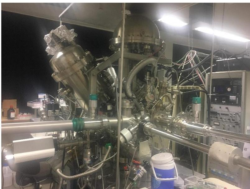
*Figure II-19 : photographie du montage expérimental XPS utilisé à l'ICPEES.*
