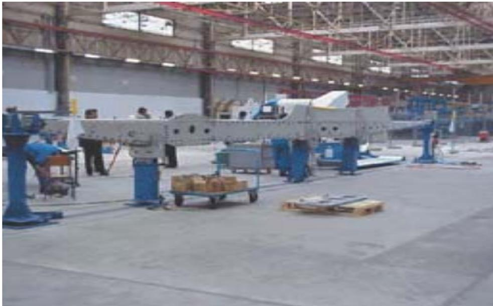
**Fig. I.31** Poutre ventrale composite sur avion Airbus A340-500/600. Pièce de 16 m de long en composite monolithique fibre de **carbone** dans une **résine époxyde**
