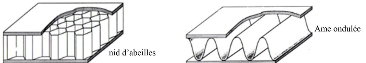
**Fig. I.28** Matériaux sandwiches à âmes creuses
